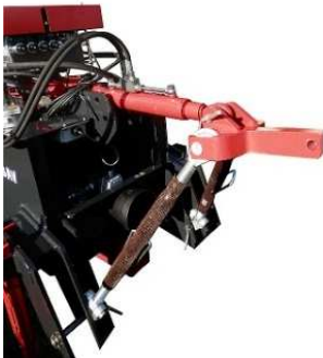
Attelage automatique des haubans Exclusivité YANIGAV 3 ème point hydraulique
