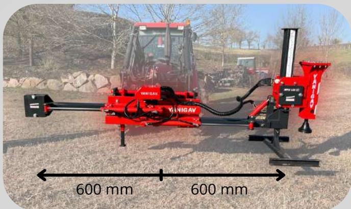
1. Double déport hydraulique de 600 mm (Marteau et masse)
